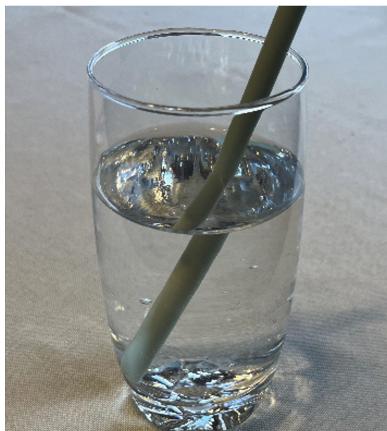
Figure 2 : Une paille dans un verre d'eau. La réfraction de la lumière fait apparaître la paille courbée et disjointe dans l'eau.
